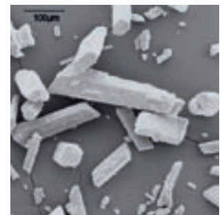
Konventionelle Airpolishing-Pulver • Partikelgröße bis 200 µm • Anwendung aufgrund der Abrasivität nur ein Mal, höchstens zwei Mal jährlich empfohlen
